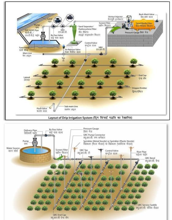
Layout of Sprinkler Irrigation System (छिड़काव सिंचाई प्रणाली का रेखाचित्र)
