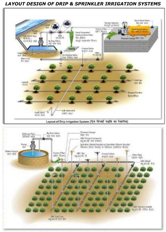
Layout of Sprinkler Irrigation System (विद्रकाम विनाई प्रणाली का रेखानिज)
